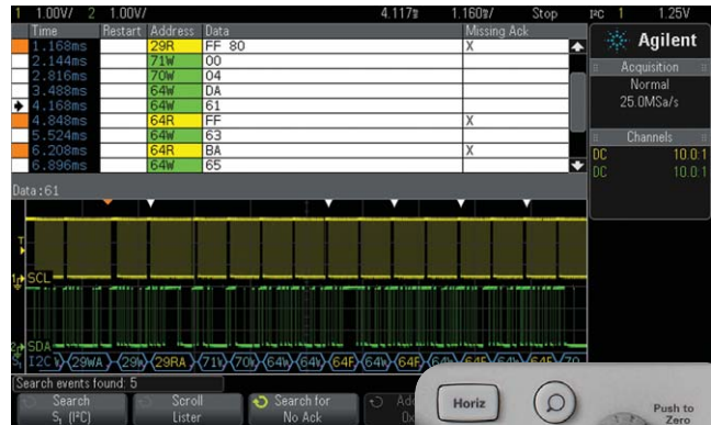
Figura 2: A função automática de "Search & Navigation" encontra rapidamente os quadros/bytes dos barramentos seriais especificados pelos usuário
