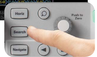
Figura 2: A função automática de "Search & Navigation" encontra rapidamente os quadros/bytes dos barramentos seriais especificados pelos usuário
